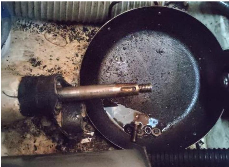
これだけの工具を駆使した。固着した原因は、パッキンから溢れた海水がフランジに浸水して錆び付いたと推測する。
