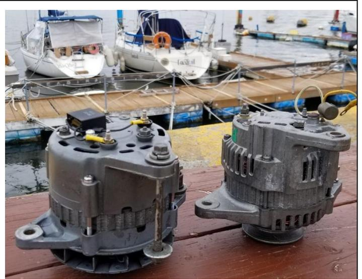
試運転中の3GM30Fに取り付けて、アンメーターで計測……約13Vの発電で再生OK!!
