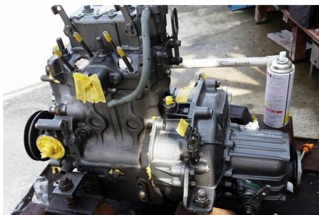
養生して Yanmar の専用塗料で塗装
