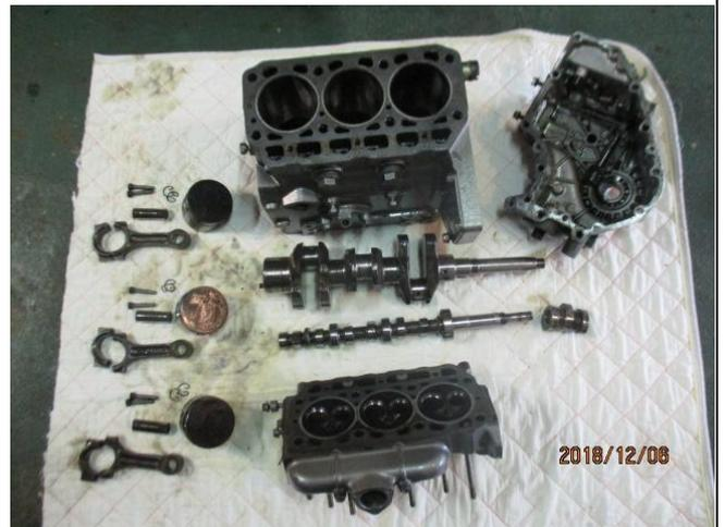
コンロッド・ピストン・シリンダーブロック・ギアハウジング
