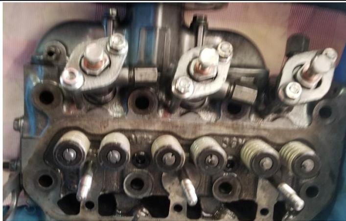
吸・排気 Valve を全て交換、Oil stem seal も全て交換
